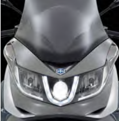
Faro abbagliante poliellissoidale centrale con guidaluce D.R.L. (Daytime Running Light)
