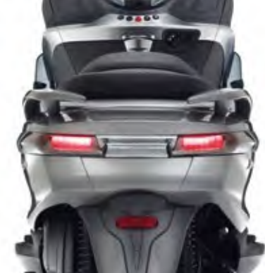
Luci di posizione e stop con led a doppia intensità
