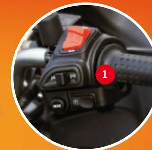
COMANDO BLOCCO SOSPENSIONE (1) POSIZIONATO DIRETTAMENTE SUL MANUBRIO E LEVA DEL FRENO (2) DI STAZIONAMENTO DIETRO ALLO SCUDO.
